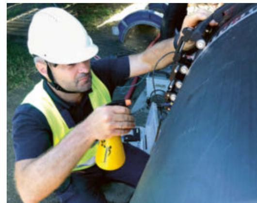
↑ À Tahiti, les inspecteurs ont vérifié avec des scanners les cordons de soudure des tuyaux qui ont dû être préparés à cet effet.
