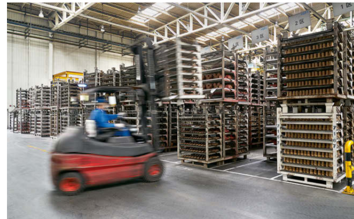
En el almacén principal de la planta se amontonan las piezas fundidas producidas, como cojinetes oscilantes, soportes de ruedas, brazos de control o cárteres de diferencial.
