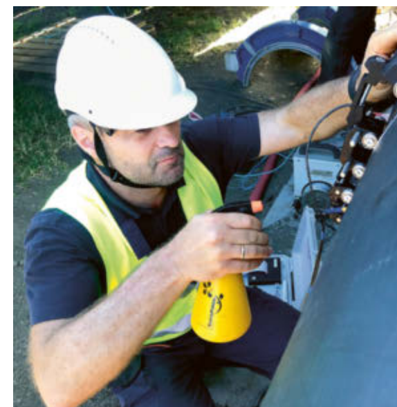
↑ 大溪地的检测人员使用扫描仪检查管道焊缝，确保万无一失。
