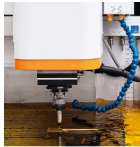
为了制造 LHC 粒子加速器的细丝部件，CERN 自 2021 年 3 月以来一直使用 CUT P 800：机器内部的巨大能量确保对金属进行比铣床更精确的加工。
