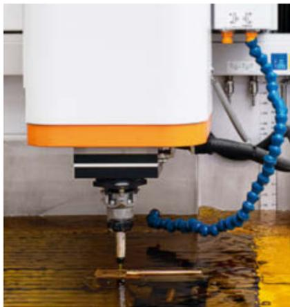
Para fabricar los intrincados componentes del acelerador de partículas LHC, el CERN utiliza desde marzo de 2021 la CUT P 800. La enorme energía del interior de la máquina hace que los metales se puedan mecanizar con mayor precisión que con una fresadora.
