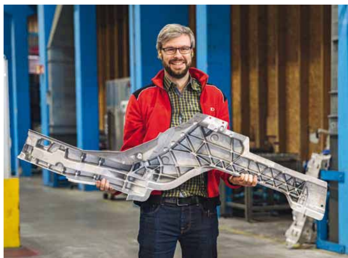
Marc Hummel avec l'élément de liaison seuil de porte-longeron de 1,43 m de long
