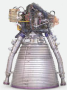
Vulcain 2.1 驱动装置高 3.7 米，重量超过两吨。
