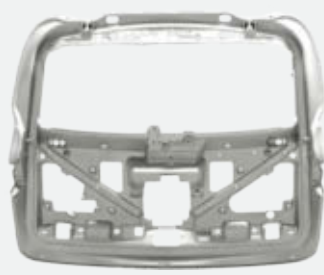
Bu otomobil parçası, Big Casting işlemi kullanılarak üretilmiş. Bir bagaj kapağının çerçevesi.
