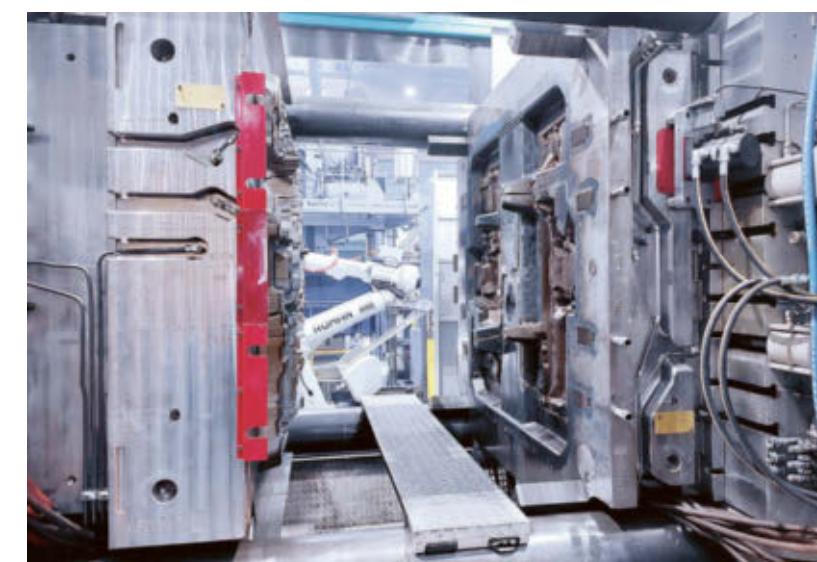
↑ Cette installation de moulage sous pression peut faire du Big Casting. Elle se trouve dans l'usine GF d'Altenmarkt (Autriche).
