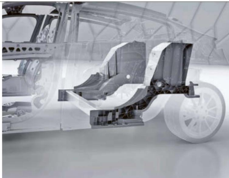
铸造。只要有可能，我们会开发模具，使其能够用4,400吨的大型压铸机生产”。GF成型方案首席技术官(CTO) Frank Gensty说道。通过这种方式，客户方连接零部件的接合工艺以及安装步骤将显著优化。
