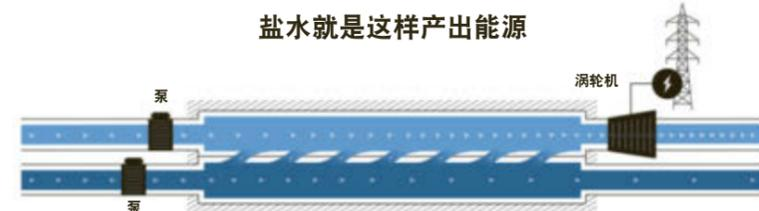
这就是SaltPower方案的运作方式：系统通过两个水箱泵送淡水和盐水，这两个水箱用具有微小孔隙的膜隔开，该膜只有水可以穿过。为实现自然平衡，淡水会自动穿透膜并与盐水混合，以平衡不同的盐含量。这种受控的水转移形成压力，驱动涡轮机，从而发电。
